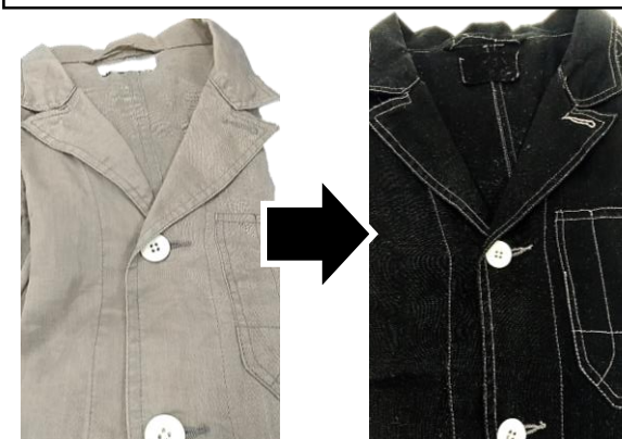
例2 麻生地だけ黒くなり、ステッチが白浮きする例
